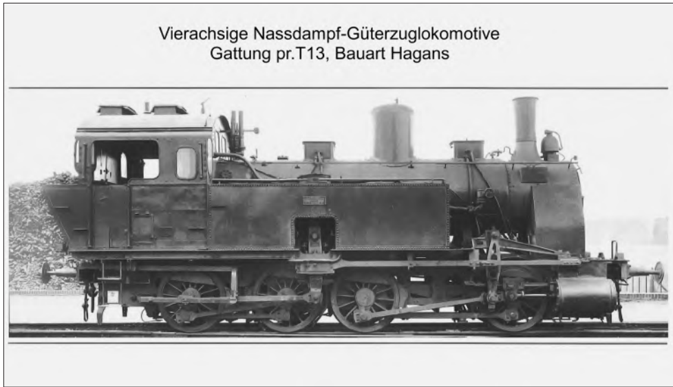
Abb. 3: Hier ist der senkrechte Schwinghebel einer Hagans-Gelenklok gut zu erkennen
